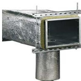
перпендикулярным размещением волокон к изолируемой поверхности, благодаря чему являются прочными и упругими, а также не меняют свою первоначальную толщину на изгибах и углах.
