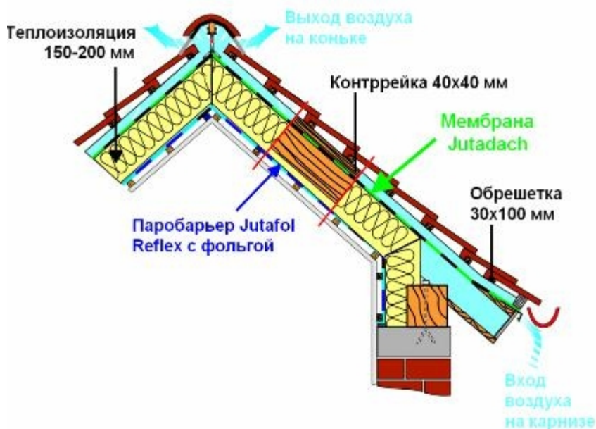
Рис.3. Схема монтажа крыши
